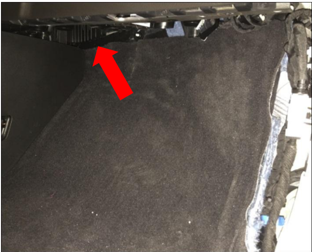
右踏板电机布线：通过副驾驶位把线隐藏在海绵下，延伸至迎宾踏板处（虚线）
