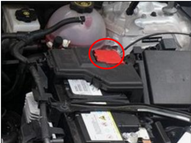
接正极：用我们的红色正极线接原车电瓶正极，正极连接片卡在螺栓上，再把螺母拧紧，（圆圈）
