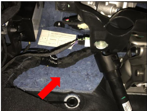
布正极线：掀开此处装饰棉，找到正极穿线孔，正极线从此处穿到车头，用尖锐工具做引线把正极穿出车头；
