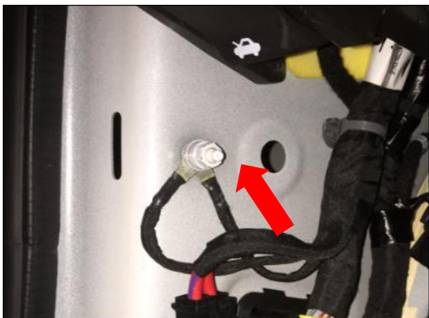
接负极：在驾驶室左下角内侧边缘位置找到我们要接的负极，负极连接片卡在螺栓上，再把螺母拧紧，（箭头）。
