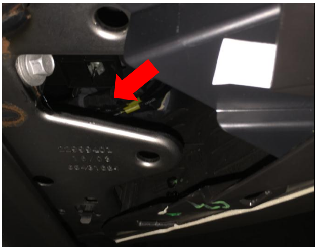
安装 ECU 把 ECU 上的 3M 胶离型纸撕走贴在内壁部，线束用扎带在原车孔扎好固定，防止松动或脱落；
