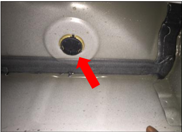
踏板电机穿线孔：将右电机线由此孔穿进车内（箭头），然后把胶塞穿进线内，待线穿好后车底对应孔周边打防水胶，把孔封好防止进水。左右两边踏板电机穿线孔方法一致；
