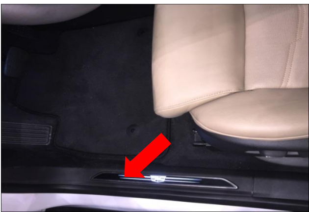
用撬具拆下前门迎宾踏板并妥善保管，注意线插头；后续还原安装。 提示：左右两边方法一致。
